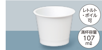
製品名 TS 71-54-107 サイズ 口径:70.0 全高:54.0 (mm) 首下径:63.4 底径:49.7 ケース入数 1,200 個 加飾 インモールドラベル
